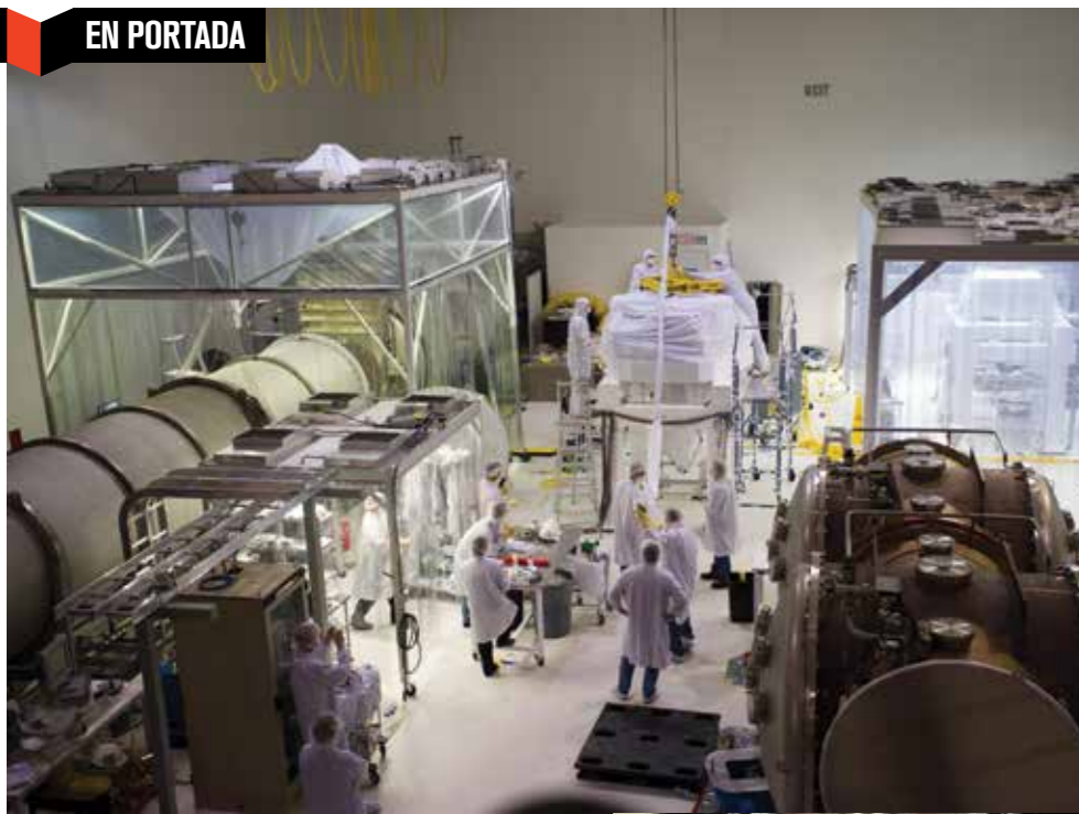
PROCESO. Arriba: ensamblaje del sistema de vacío de LIGO. Derecha: inspección final de uno de los espejos.
